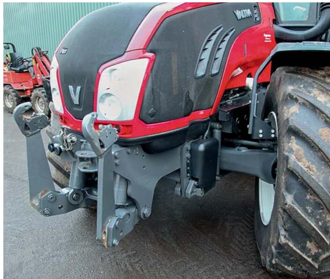
Das Fronthubwerk baut wohl weit nach vorne, aber nicht zuletzt dank der luftgefederten Vorderachse ist der Fahrkomfort des T prima.
