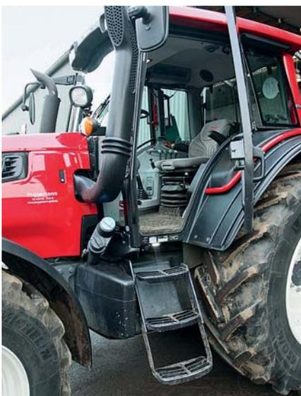
Der Aufstieg ist okay, auch wenn die Trittstufen komplett ungeschützt sind. Der AdBlue-Tankstützen ist links, der SCR-Katalysator für die Abgasstufe IIIB sitzt auf der rechten Seite unten vor der Kabine.
