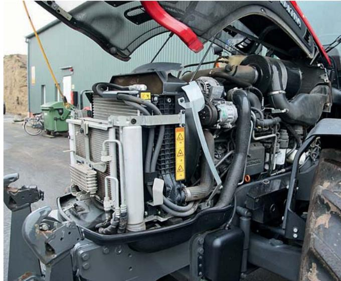
Der Sechszylinder von AgcoPower mit 7,4 l Hubraum überzeugt mit Laufruhe und Leistung. Auch der Verbrauch ist in Ordnung – und Motor-Probleme sind auch bei den älteren Valtras auf dem Betrieb unbekannt.
