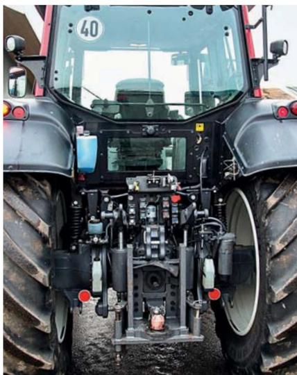
*Für die Transporte wird das Hubgestänge komplett demontiert. Außer eines defekten Rücklichts gibt es im Heck aber wenig zu meckern. Allerdings ist der „HiTech“ nur mit Zahnradpumpe lieferbar, so dass Hubwerk und Steuergeräte nicht gleichzeitig arbeiten.*
