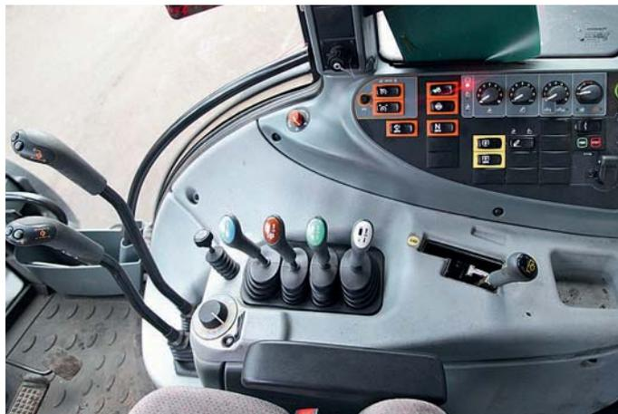
*In der „HiTech“-Ausstattung geht es sparsam zu, aber jeder Fahrer kommt sofort klar. Es gibt nur drei Lastschaltstufen und zwei Zapfwellen-Drehzahlen. Außerdem werden die mechanischen Ventile seitwärts bedient.*
